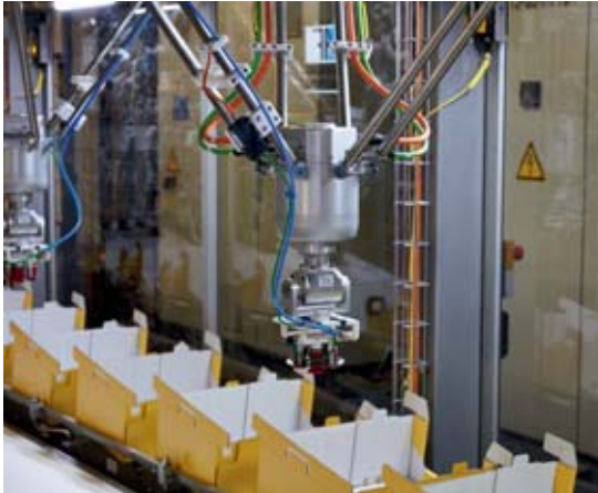
Schnelle Eingreiftruppe: Insgesamt vier Delta-3-Picker befüllen die Kartons nach einem verschachtelten Packschema drei- oder vierlagig.
